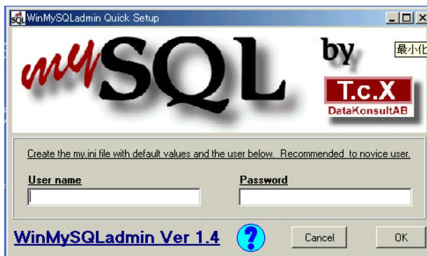
起動した WinMySQLAdmin はタスクバーに収まり、動作状態を信号のランプで示します。青色を表示しているときは作動しています。タスクバーの信号アイコンを右クリックして表示されるショートカットメニューから [Show me] をクリックしてください。
